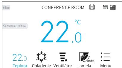
2 Stlačením tlačidla „^“ sa teplota zvýši o 0,5 °C na maximum 30 °C.
