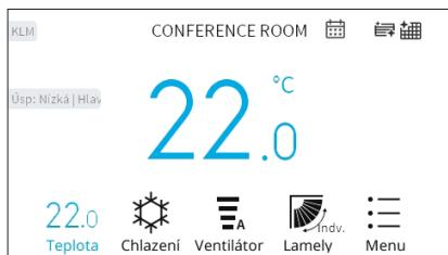
2 Stisknutím „^“ teplota po 0,5 °C stoupne až na maximálních 30 °C.
