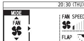
6. Durante il funzionamento in modalità VENTOLA (dopo almeno 5 minuti di funzionamento), premere simultaneamente □ + ▶ + ▶ per almeno 4 secondi per visualizzare "Maintenance func" (Funzione manutenzione).
